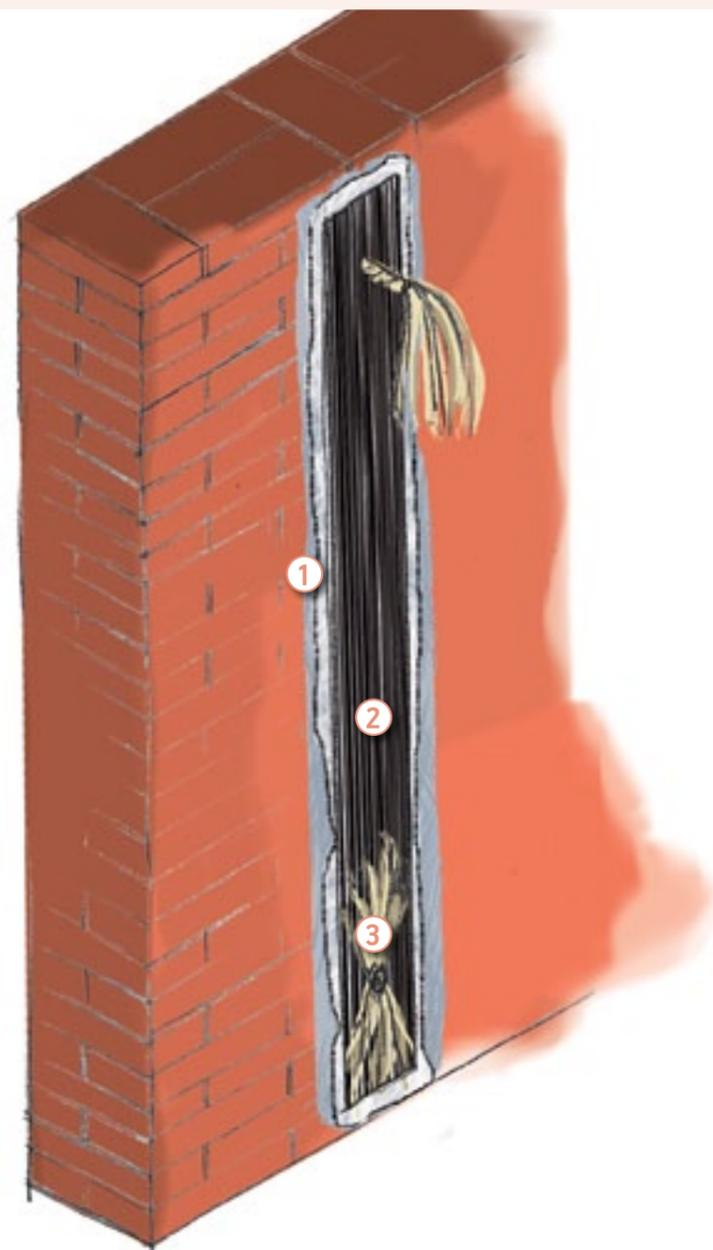
**IL PROBLEMA** La lunghezza di ancoraggio delle fibre è superiore allo spazio disponibile; sono presenti delle concavità che provocherebbero il distacco del rinforzo quando esso va in trazione.
