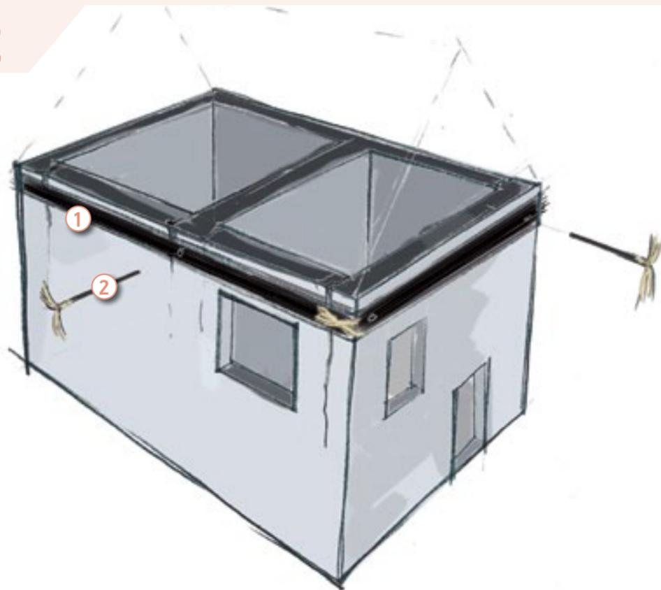
**IL PROBLEMA** Si teme la formazione di un cinematisma consistente nel ribaltamento del pannello murario rispetto ad una cerniera cilindrica alla base del pannello murario stesso.
