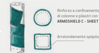
Rinforzo a confinamento di colonne e pilastri con tessuti ARMOSHIELD C - SHEET
