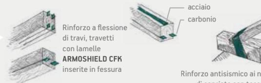
Rinforzo a flessione di travi, travetti con lamelle ARMOSHIELD CFK inserite in fessura
