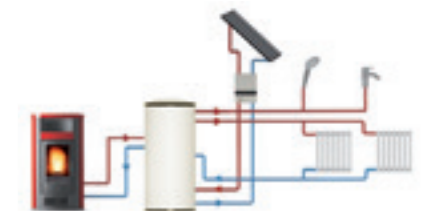
Riscaldamento con il solare termico Solar heating
